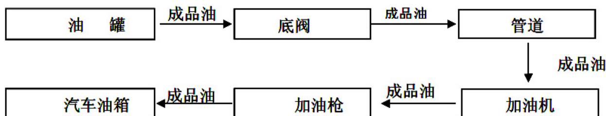
图 2.6-3 柴油加油工艺流程示意图
