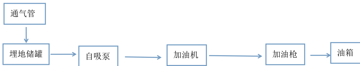
图 2.6-4 柴油加油工艺流程示意图
