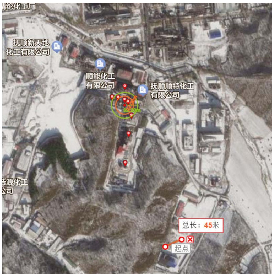
图 F4.4-5 罐区一（一甲胺）储罐泄漏扩散事故后果模拟图
