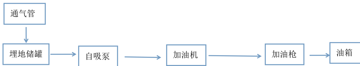
图 2.6-4 柴油加油工艺流程示意图
