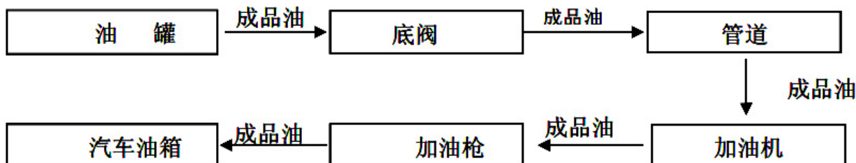
图 2.6-3 柴油加油工艺流程示意图
